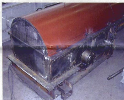
Безроликовый конвейер в процессе сборки. Цех изготовления оборудования ОАО «НИИпроектасбест».
