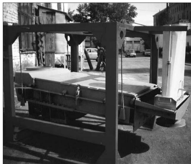
Рис. 2. Грохот инерционного типа – сортировка
