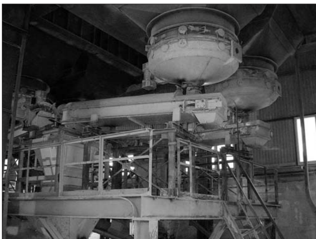
Рис. 2. Вариант установки виброактиваторов бункерных на заводе сухих смесей ЗАО «Корпорация «Атомстройкомплекс»
